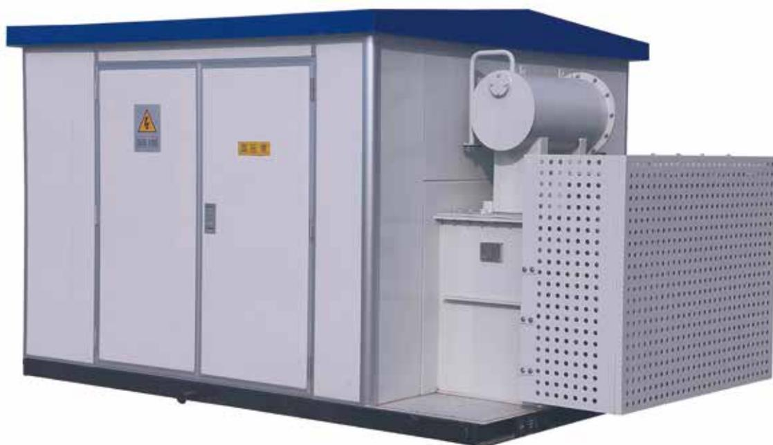
风电箱变有35kV和10kV两种,可采用美式箱变或欧式箱变两种模式,美变适合小容量可靠性要求不高的小型风电机组使用,采用品字型布局结构,欧式箱变适用于大容量风电机组使用,功能扩展空间大,一般采用欧式目字型布置,合理有效利用空间。缩短了建设周期,降低了工程造价,提高了电网运行的可靠性。
