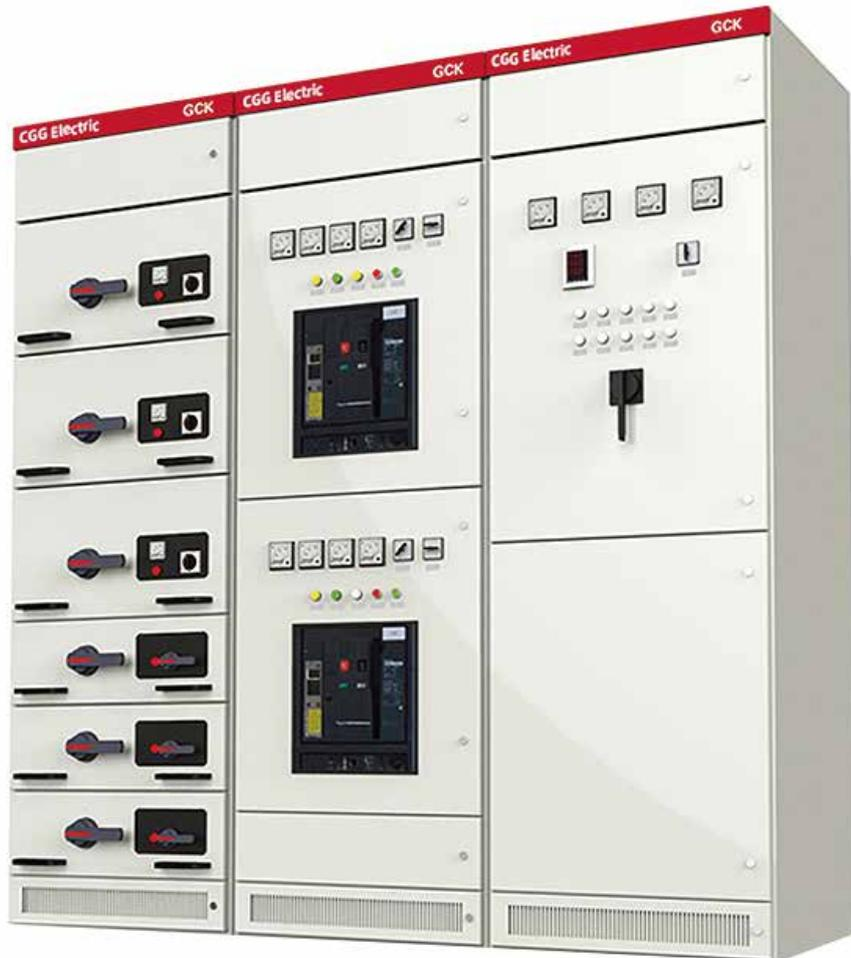
GCK型低压成套设备,适用于交流50~60Hz、额定工作电压至660V、额定电流6300A及以下的供电系统,广泛应用于发电厂、变电站、工矿企业、高层建筑等领域的低压配电系统中,作为受电、馈电、无功功率补偿、电能计量、照明及电动机控制中心等电能转换、分配与控制。
