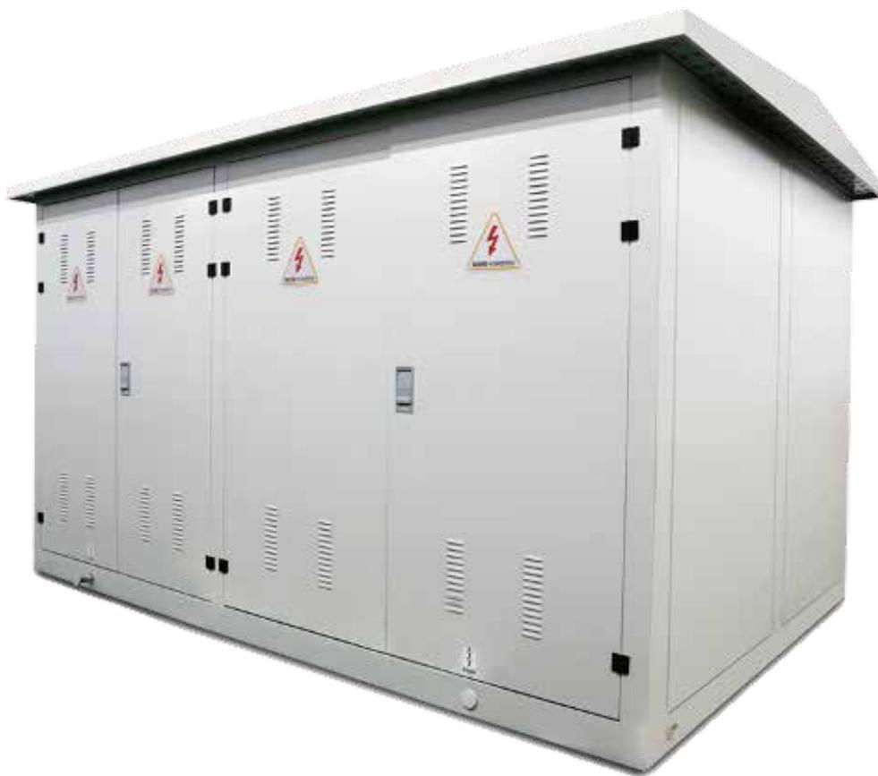
智能型预装式变电站是将中压柜、变压器、低压柜等设备集中安装于密封、防潮、防锈的箱体内部，是配电系统一、二次一体化的户外装置。适用于额定电压7.2~40.5kV/0.4~0.69kV、三相交流50/60Hz电力系统，主要应用于高层建筑、住宅小区、公园、厂矿、宾馆、油田、机场、码头、铁路及临时性设施等户外用电场合，作为接受、转换和分配电能之用，并对电路实行控制、保护和监测。
