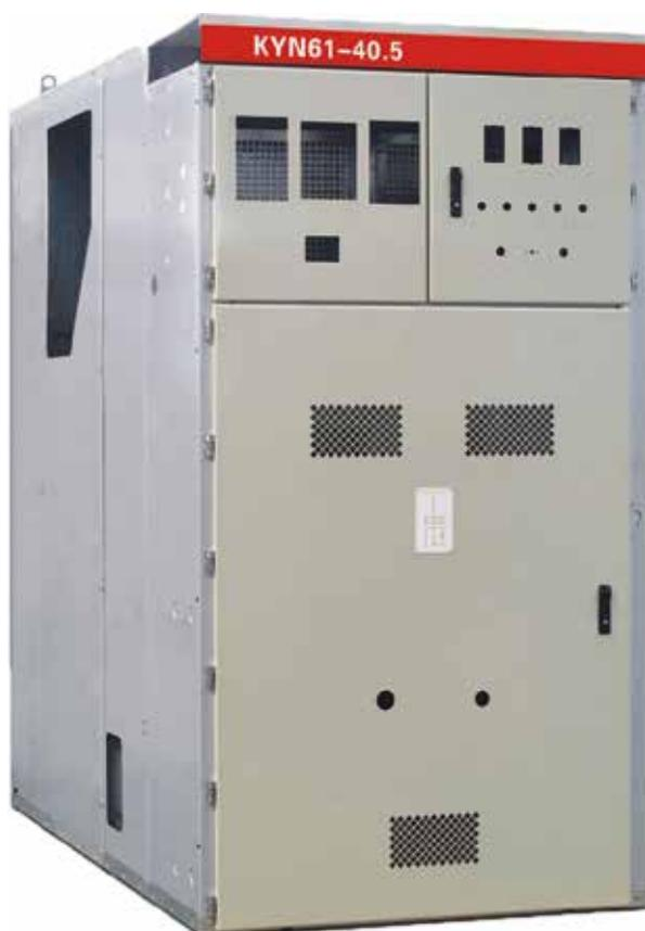
KYN61铠装移开式交流金属封闭开关设备适用于40.5kV三相交流50/60Hz单母线及单母线分段电力系统,主要应用于发电厂、变电所及工矿企业、高层建筑等变配电场合,作为接受和分配电能之用,并对电路实行控制、保护和监测。
