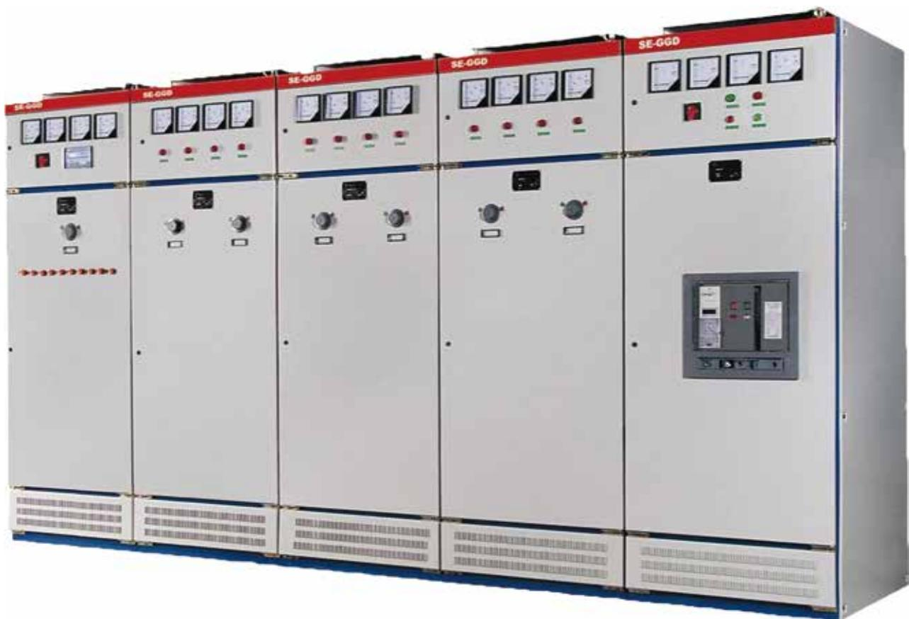
GGD低压成套设备适用于交流50/60Hz、额定工作电压至660V、额定电流6300A及以下的供电系统，广泛应用于发电厂、变电站、工矿企业、高层建筑等领域的低压配电系统中，作为受电、馈电、无功功率补偿、电能计量、照明及电动机控制中心等电能转换、分配与控制。产品本着安全、经济、合理、可靠的设计原则，具有分断能力高、动热稳定性好、电气方案灵活、组合方便、系列性与实用性强、结构新颖等特点。
