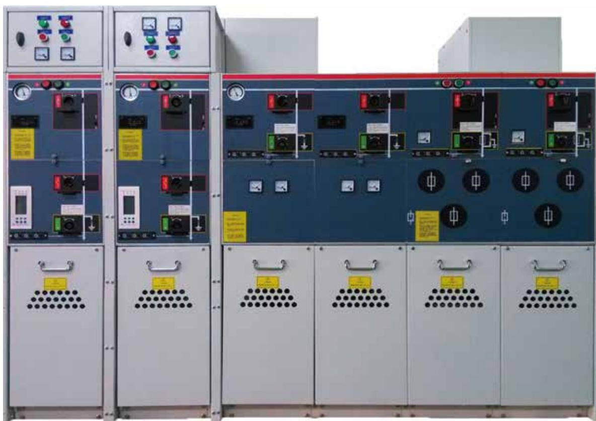
XGN-12/24型户内交流高压六氟化硫环网开关设备(以下简称“环网柜”)是新一代以六氟化硫负荷开关作为主开关而整柜采用空气绝缘的、适用于配电自动化的、既紧凑又可扩充的金属封闭开关设备。
