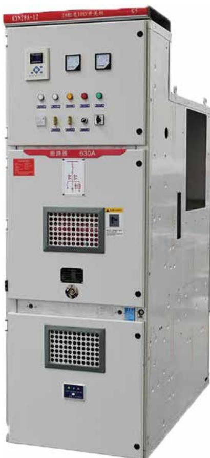
KYN28铠装移开式交流金属封闭开关设备(以下简称设备)适用于3.6~12kV三相交流50/60Hz单母线及单母线分段电力系统,可满足海拔3500米要求,主要应用于发电厂、中小型发电机送电、工矿企事业单位配电以及电力系统二次变电所的受电、配送电及大型高压电动机的启动之用,对电路实行控制、保护和检测。
